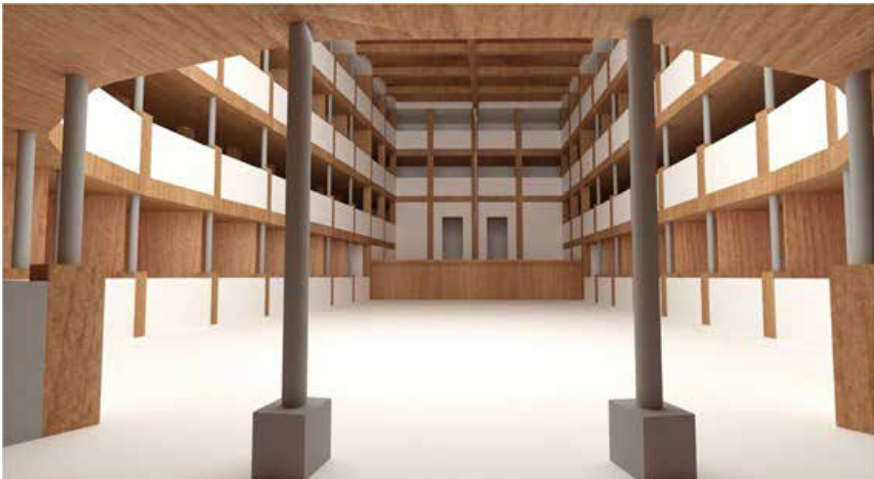
Figuras 16 e 17 – 3D da estrutura do interior do Pátio das Arcas (1707).
