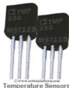
Figure 6: Sensores de temperatura.
