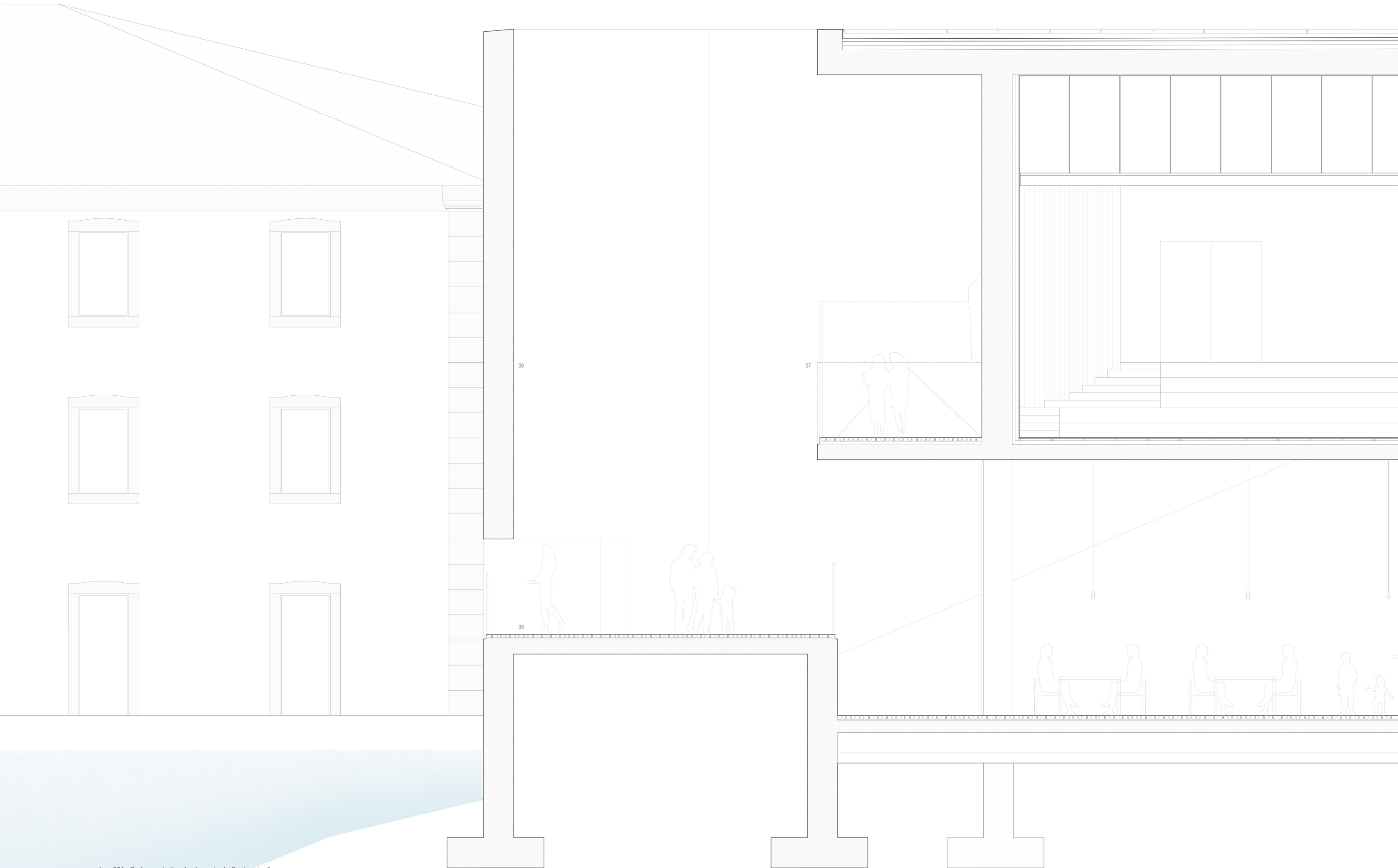
Img 051 . Corte construtivo do elemento de Contemplação
