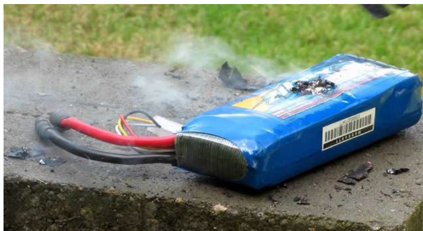
Figura 14 - Bateria LiPo danificada
