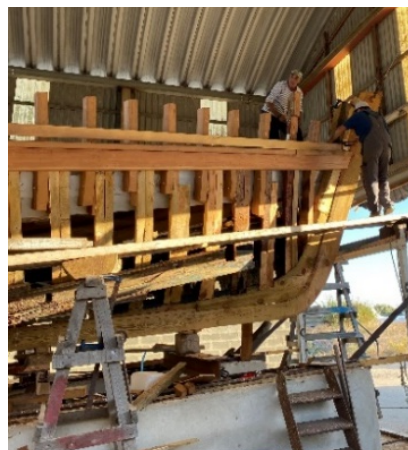
Figura 51. Mestre Jaime e um funcionário a trabalhar na tábua da boca. Fonte: estaleiro naval de Jaime Costa.
