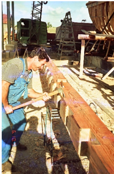
Figura 17. Mestre Jaime Costa a aparar os cavalos da sobrequilha.
