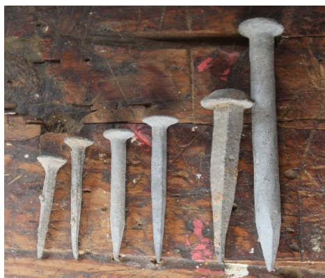
Figura 25. Pregos de cabeça redonda fabrico artesanal, no estaleiro naval de Sarilhos Pequenos, Fonte; fotografia de autor.
