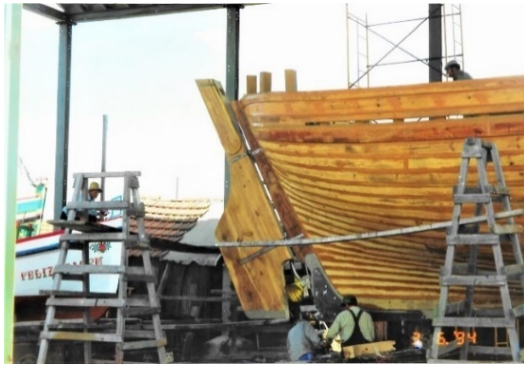
Colocação do leme. Fonte: Celso Santos.
