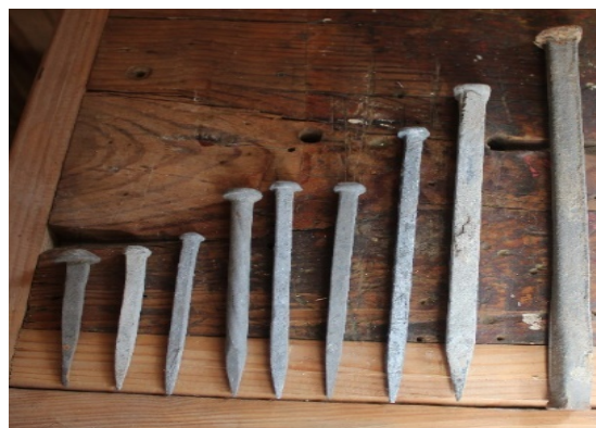
Figura 26. Pregos de cabeça quadrada fabrico artesanal no estaleiro naval de Sarilhos Pequenos. Fonte; fotografia de autor.
