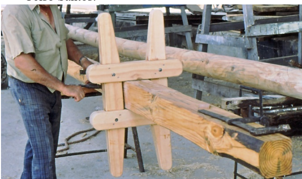
Colocação dos vaus no mastro. Fonte: Celso Santos.
