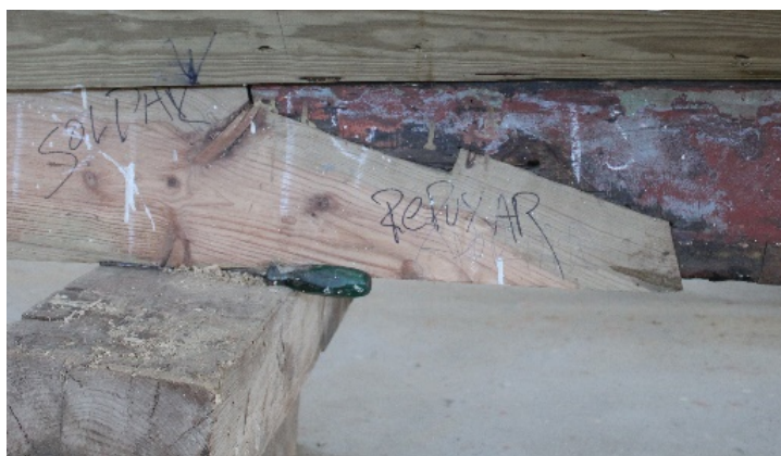
Figura 27. Escarva na quilha da embarcação “Riga”, no estaleiro naval.
