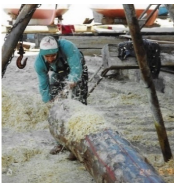
Corte e preparação do tronco. Fonte: Celso Santos.
