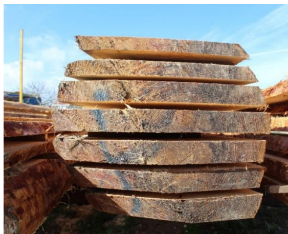
Figura 22. Madeira com espaçamento entre tábuas, para permitir que respire. Fonte: fotografia de autor.
