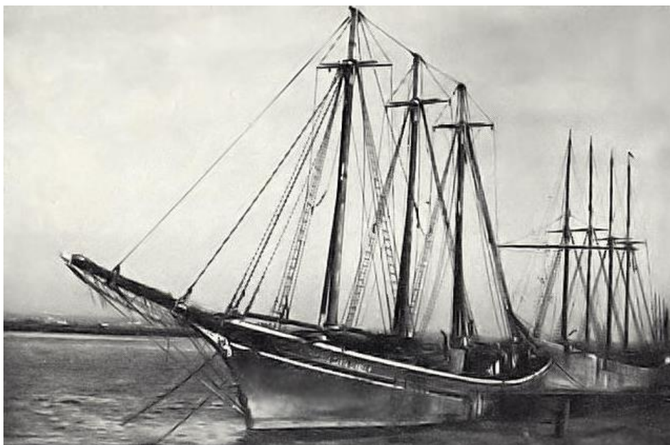
Fig. n.º 43, Fotografia dos lugares de quatro mastros “Rainha Santa Isabel” e “Senhora da Saúde”, em 1929. 200 , onde pode ser observada a configuração dos mastros e da amura de bombordo.
